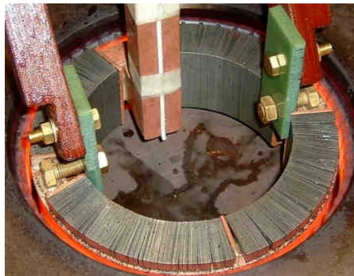
← Härtekopf für Gelenkgehäuse Forminduktor mit Feldkonzentratoren Abschirmbrausen außen
