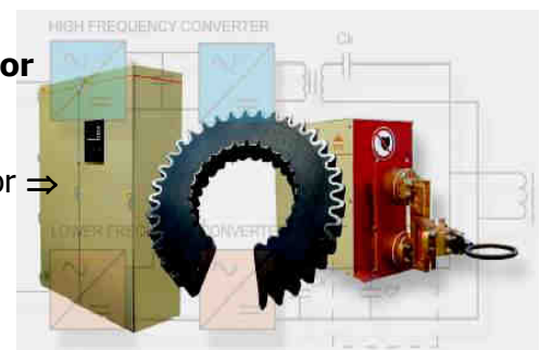
← Härtekopf für Gelenkgehäuse Forminduktor mit Feldkonzentratoren Abschirmbrausen außen
